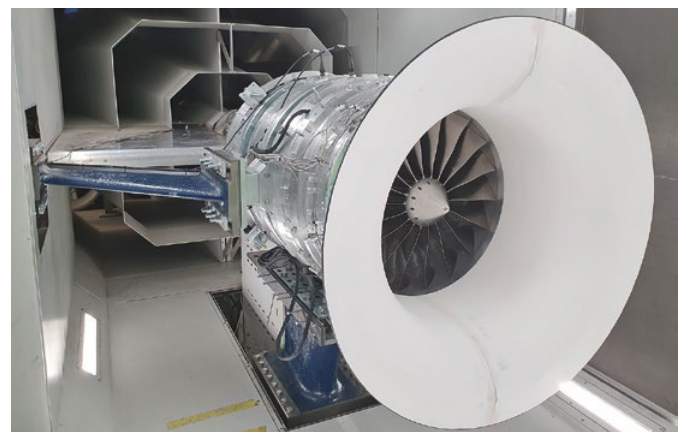
Im Propulsor-Prüfstand untersucht das Institut für Flugantriebe und Strömungsmaschinen der TU Braunschweig zukünftige Triebwerke.
